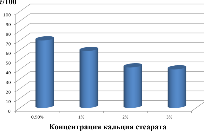
Рисунок 1. Зависимость сыпучести смеси от концентрации кальция стеарата
